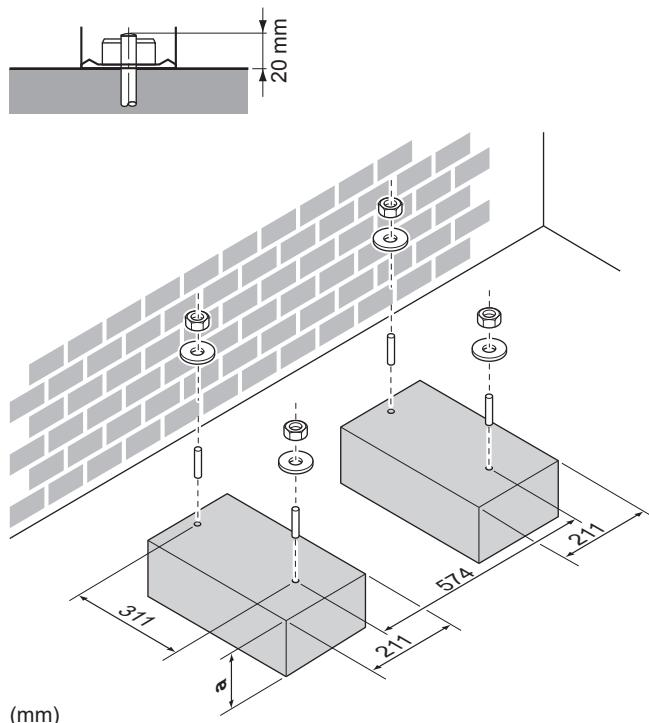
**a** 100 mm virs paredzamā sniega segas līmeņa
